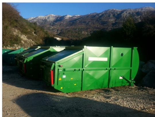
Slika 10 Pres kontejneri za transport usitnjenog otpada
