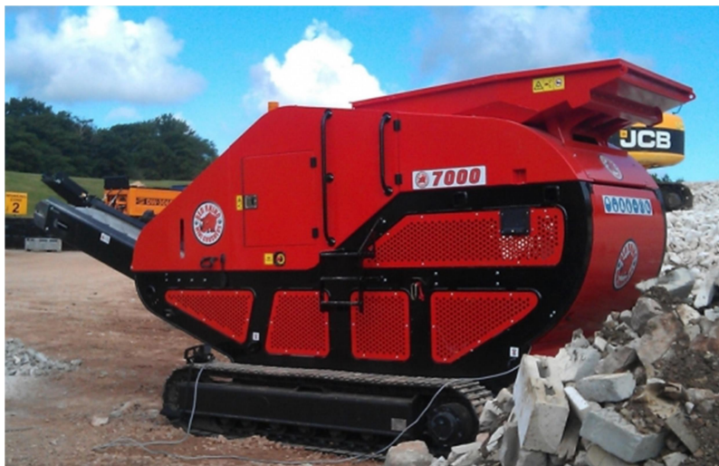
Slika 22 Čeljusna drobilica za građevinski otpad (beton, kamen, cigla i dr)
