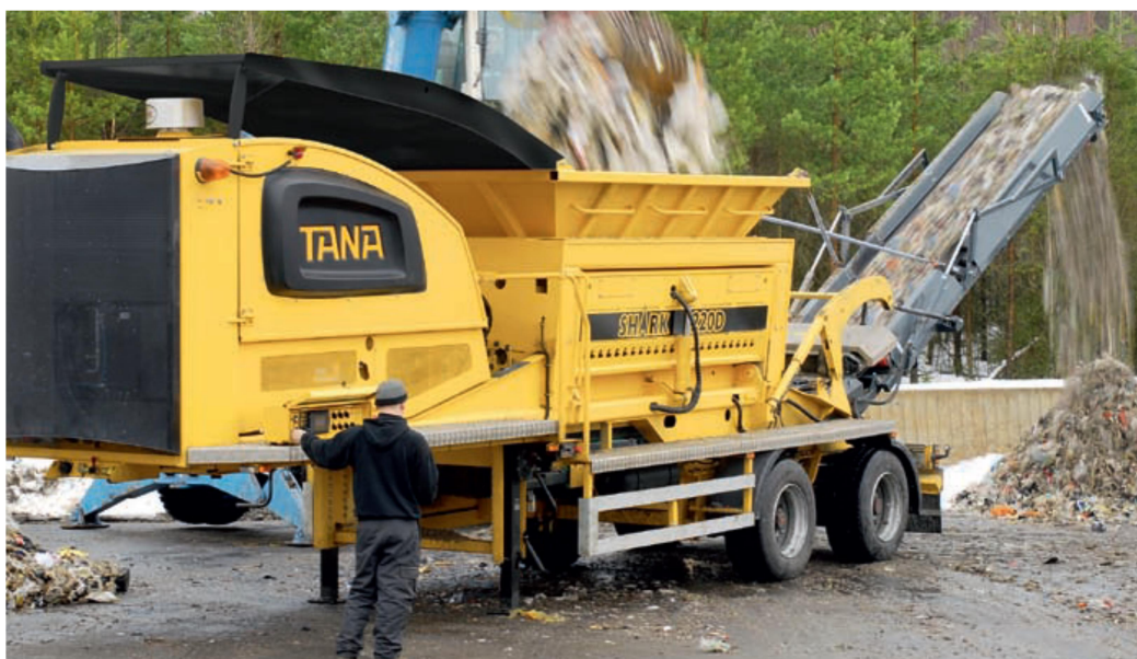
Slika 23 Specijalna mašina za usitnjavanje komunalnog otpada na deponiji
